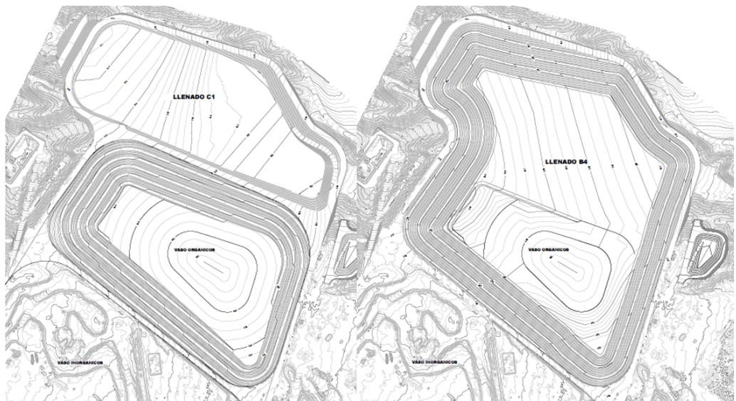
Figura 3. Situación inicial y final del Proyecto de ampliación del vertedero. Fuente: Proyecto
