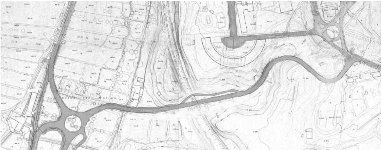
**Valoración.-** Se considera aceptable el nuevo trazado definido para el sistema general, separando en la zona del paso inferior actual el tráfico ciclista del rodado, que precisará una nueva estructura tipo marco bajo la plataforma del ferrocarril. La mayor anchura de calzada prevista exigirá expropiaciones y demoliciones, al amparo de lo previsto en el artículo 188 del Texto Refundido de la Ley de Urbanismo de Aragón.
