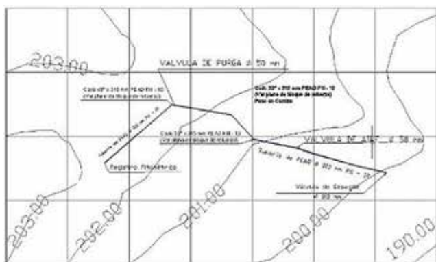
Figura 5. Proyecto de construcción de una conductora.
