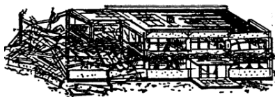
Figura 1b. Categorías y descripción de daños en edificios de hormigón armado según la EMS-98.
