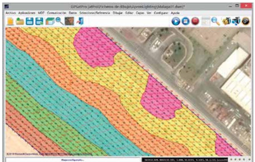
directa del barco, celda y líneas de apoyo, se va generando una base de datos en la cual se especifica el número de vertido o dragado que se ha hecho sobre el número de celda especificado, representándolo con colores, lo que nos dará una idea exacta de cuantos vertidos se han hecho en una determinada celda.
