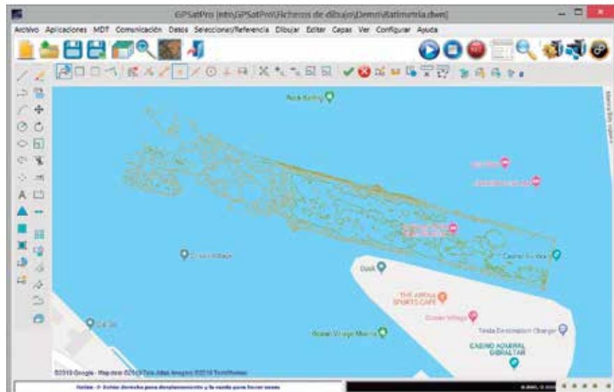
sentados sobre el mapa podemos realizar el levantamiento topográfico, replanteo y dibujo de nuestro proyecto dentro de un interface gráfico muy sencillo y visual que no nos dará ninguna posibilidad a error.
